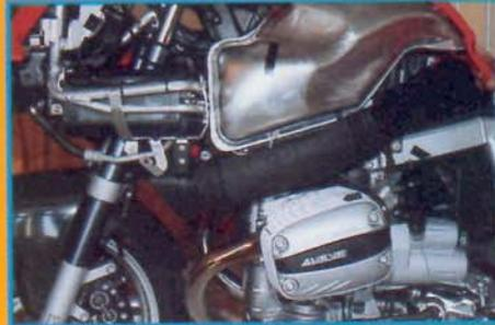
«Magnésium» sur la face supérieure ; pour ces pièces, le magnésium s'est donc substitué à l'aluminium, ce qui se traduit par un allègement de 800 gr. Conformément à son caractère sportif, la R1100S dispose d'une nouvelle boîte à six rapports, la transmission depuis le moteur étant assurée par un embrayage monodisque à sec à commande hydraulique.
